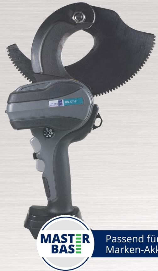
Der Kabelschneider mit Feinschliff trennt präzise und schnell fein-/feinstdrähtige Litzenleiter (Klasse 5 und 6) bis  $\varnothing$  65 mm. Speziell bei der Verlegung hochflexibler Leiter überzeugt dieses leichte, ergonomische Werkzeug mit seiner sichelförmigen Schneidgeometrie.
